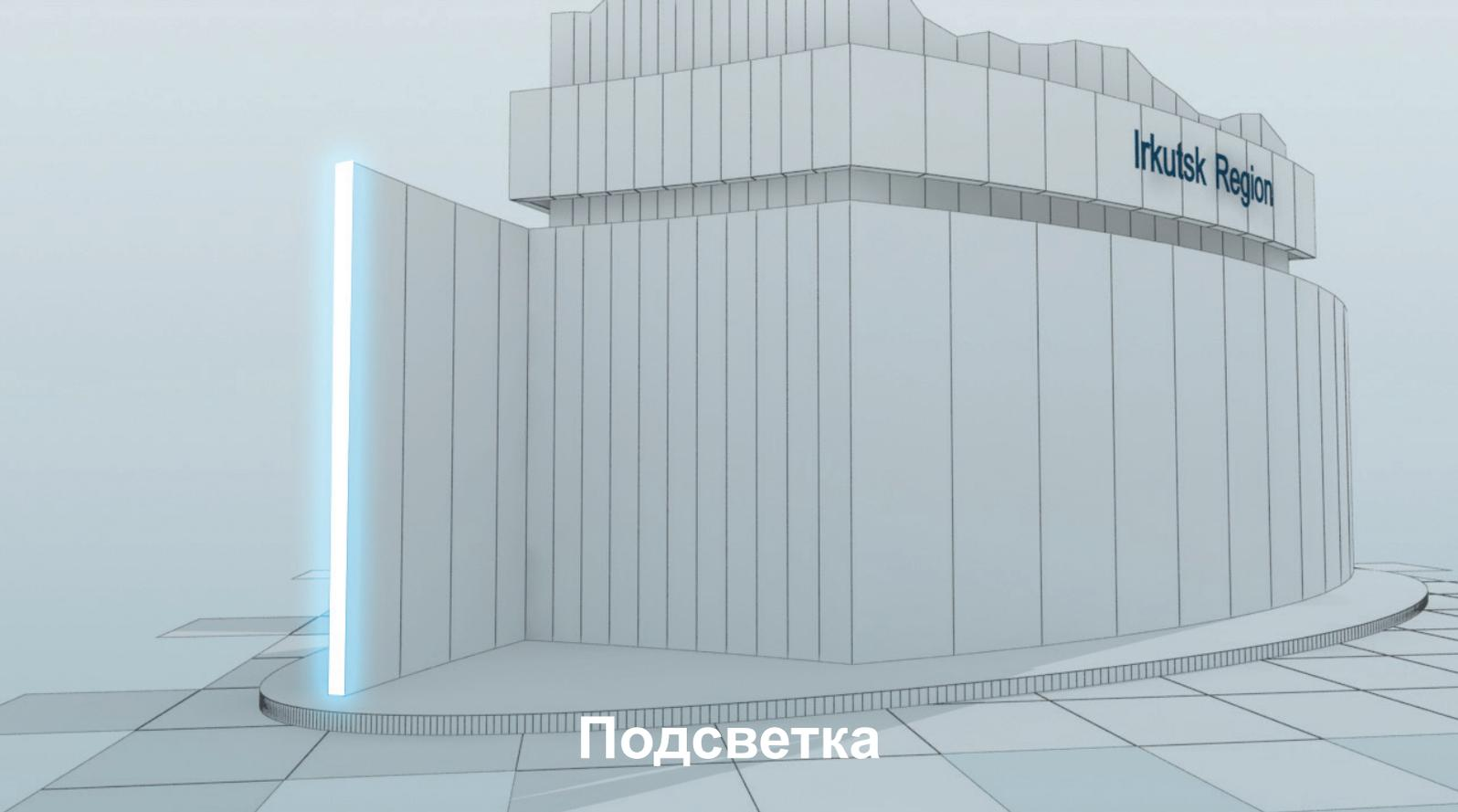
Светодиодная подсветка установлена на торцах «лепестков» главной конструкции.
